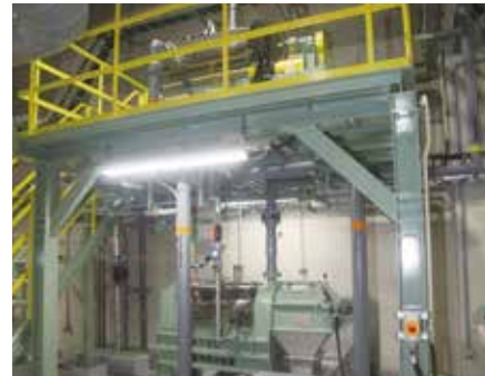
夾雑物除去装置・夾雑物脱水装置
